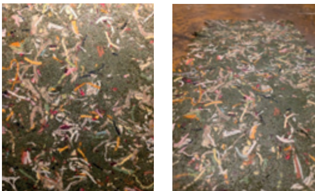
15 – 16 pav. Iš tekstilės atliekų suspausta plokštė, naudojant dervą
