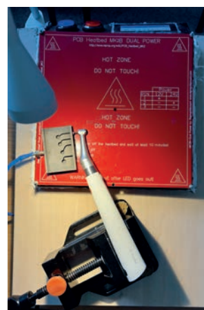
2 pav. Bendras eksperimentinės darbo vietos vaizdas: mikromotoras, pritvirtintas prie termostatinio bloko.
